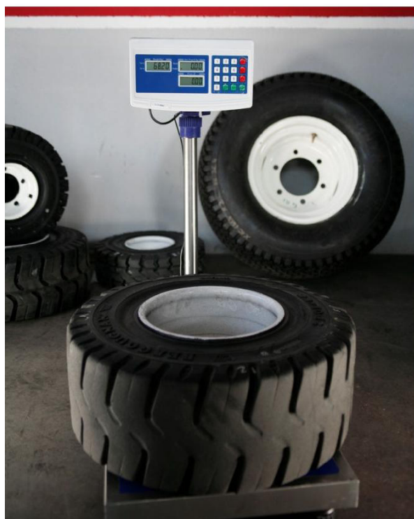
Obr. 9 a 10 – Měření hmotnosti pneumatik Elite XP a Conti SC20
