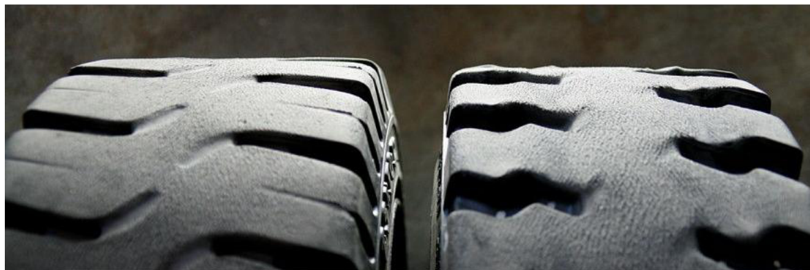
Obr. 11 – Vzorek Elite XP versus SC20 po skončení testu
