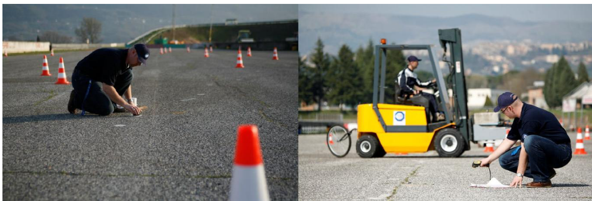
Obr. 2 a 3 – Měření drsnosti povrchu a teploty dráhy
